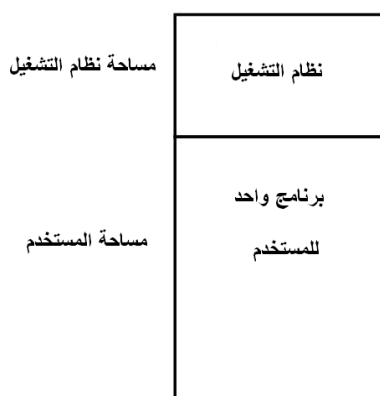
شكل رقم (4-8): شكل الذاكرة في النظام أحادي المهام.
