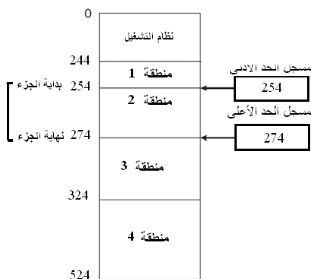
شكل رقم (6-8): شكل الذاكرة لجدول الحجز (1-8).
